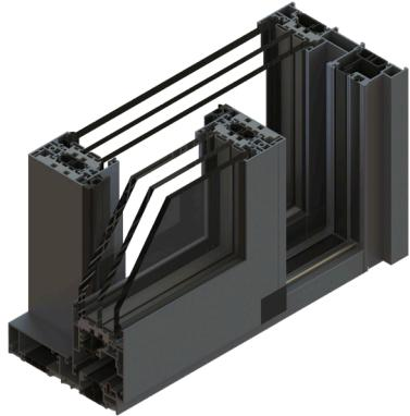
DS145 è il primo sistema scorrevole in linea pesante della nuova famiglia DOGMA con profili ridotti. I "numeri" che lo caratterizzano sono: telaio da 145mm anta da 65mm portata da 250 Kg fino a 400 Kg Uf del nodo base inferiore a 1,5W/mqK. DOGMA DS145 consente di realizzare le principali tipologie 2 o più ante con o senza fissi laterali. Ferramenta di chiusura tradizionale con riscontri sul telaio o a ganci. DOGMA DS145, il ritratto dell'eleganza.
